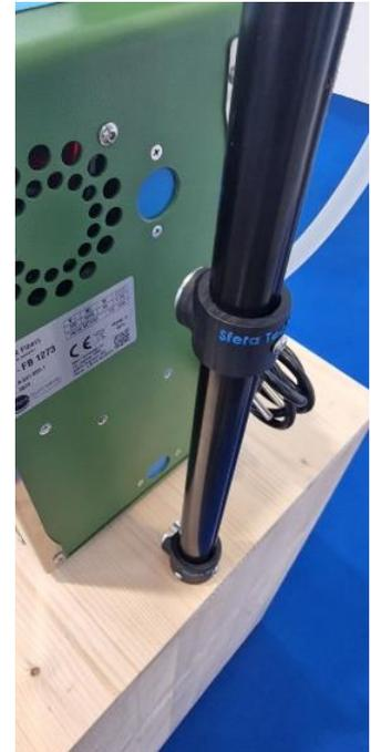
Tramite 2 magneti è possibile applicare velocemente l'asta telescopica per alloggiare il supporto con pinza dove collegare la cassetta precaricata con il filtro di campionamento.
