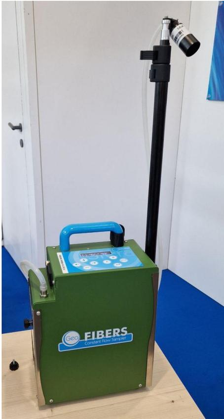
Il campionatore a portata costante modello **GEO FIBERS** è idoneo per prelievi di polveri e di amianto (SEM) in postazione fissa.
